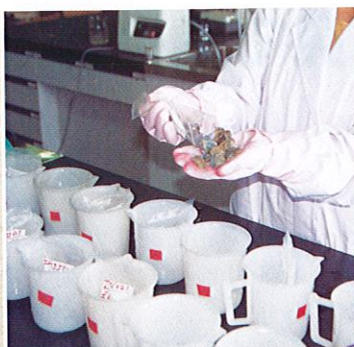
②試料をポリビーカーに移し、3%のフッ化水素酸を試料が浸る程度加える。
