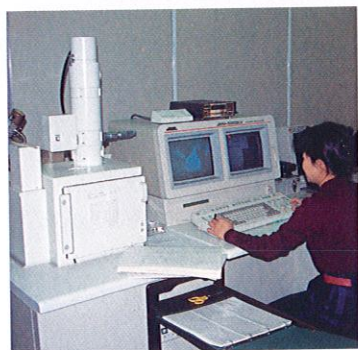
⑦放散虫化石をのせた試料台を金の薄膜で覆い、電子顕微鏡で観察をする。
