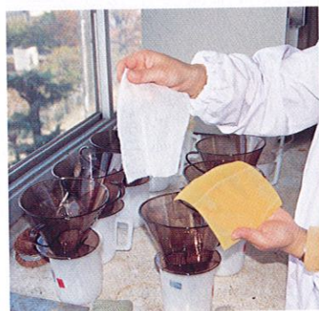
④水を加えて、洗い流すようにして試料の残渣を#60 #200の組のメッシュに通す。
