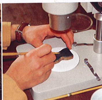
⑥試料を観察台に薄く散布し、双眼実体顕微鏡で観察する。習字用細筆で1つずつ拾い上げた放散虫化石を真鍮の試料台に固定をする。
