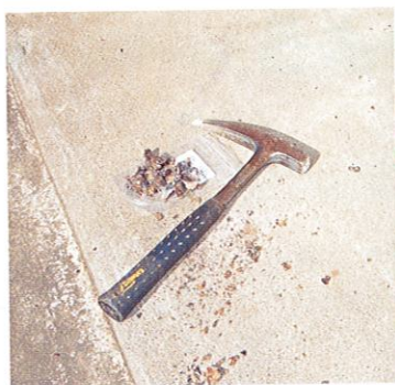
①ハンマーを用いて、試料を2～3cm程度の大きさに砕く。
