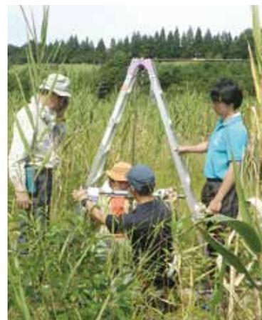
写真1 ハンドボーリングサンプラーの設置
