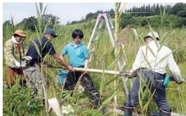
写真2 ボーラーのパイプから堆積物の取り出し
