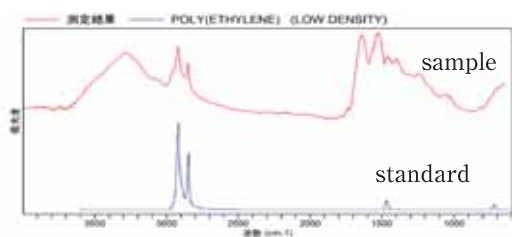
図6. 回収したプラスチックの分析 (FTIR: 赤外線吸光度計を使用、京都大学協力)
