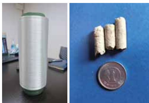
図9. 左は漁網、右は発泡フロートの再生品
